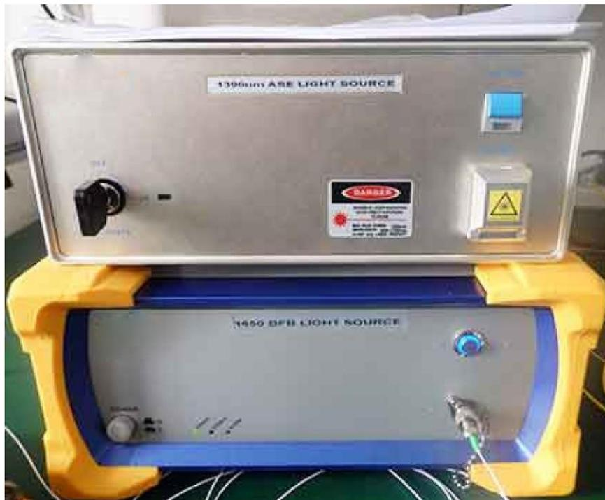
Источник света ASE с длиной волны 1390 нм и низким коэффициентом оптической плотности 1250–1650 нм (вверху)
